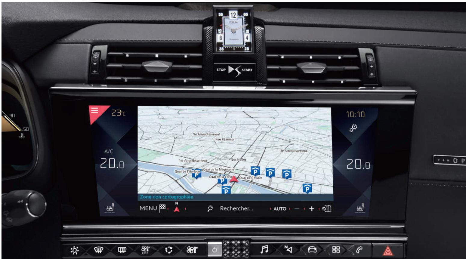
**Dotykový centrální 12"** displej umožňuje ovládat funkce vozu pomocí virtuálních tlačítek. Funkce vozu lze ovládat i pomocí chromovaného ovladače zdobeného krystaly\*. Používá se k ovládání komfortu v kabině a zároveň jako multimediální rozhraní. Ovládá se přes něj řada funkcí vozu a navigace i Mirror Screen\*\* (Android Auto™, Apple CarPlay™ a MirrorLink®).
