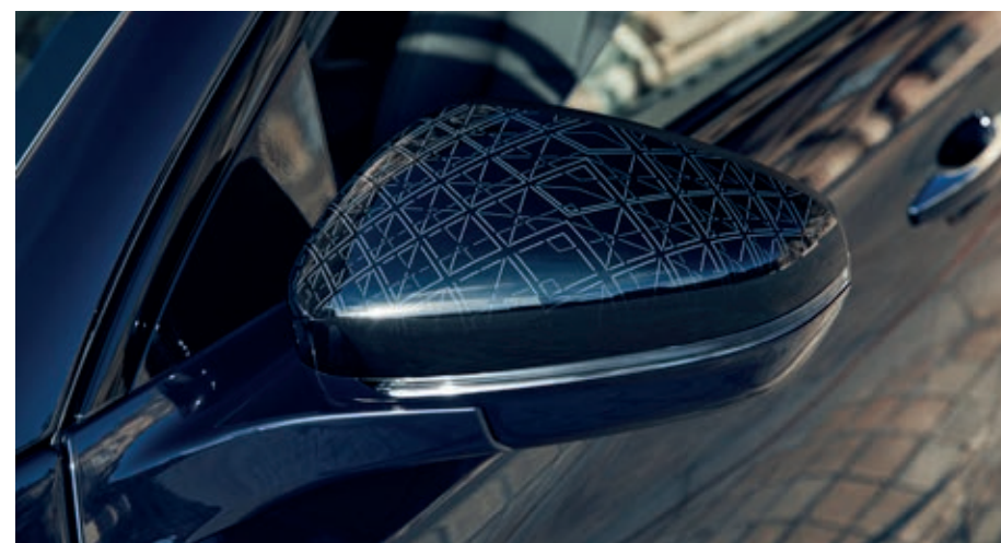
Vrchní kryt vnějšího zpětného zrcátka s laserem „vyrytým“ motivem pyramid
